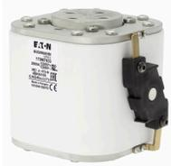
**Cartouche fusible, grande vitesse, 1500 A, AC 1000 V, 200 kA, size 4, 105 x 120 x 95 mm, aR, IEC, indicateur de type K**
