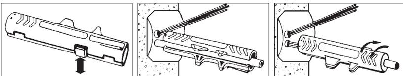
Outil à dégainer pour tout câble rond de ø 8 à 13 mm, sans aucun réglage. Idéal pour boîtiers de raccordement et boîtes de dérivation.
