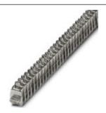
Bloc de jonction de dérivation, Type de raccordement Raccordement vissé, Courant de charge: 76 A, Section : 1,5 mm² - 16 mm², Largeur: 9,8 mm, Coloris: argenté
