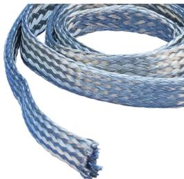
L'usage primaire de la tresse tubulaire est de fournir aux câbles sensibles un blindage EMC/EMI contre les interférences électromagnétiques, électrostatiques et radio. On obtient une performance de blindage optimale en utilisant des tresses de fils de cuivre qui peuvent également être utilisées à des fins de continuité.
