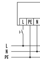
Raccordement standard avec interrupteur
