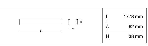
Structure porteuse SANS ligne d'alimentation pour canaux continus, adaptée au transport de lignes électriques ou à l'assemblage d'appareils.
