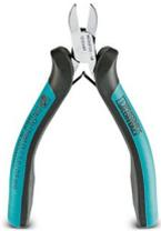
Pince coupante diagonale électronique, tête arrondie, sans chanfrein, avec ressort d'ouverture, polie effet miroir et huilée, poignée à 2 éléments, capacité de coupe de diamètre : 0,2 ... 2,0 mm si souple ; 1,2 mm si dureté moyenne ; 0,5 mm si dur, type de conditionnement : avec support pour présentoir (Backcard)
