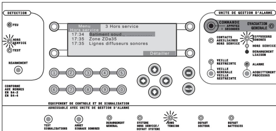
Pour mettre en/hors service des points de zone de détection, sélectionner en niveau 2 la touche "Mise en/hors service" puis l'élément à mettre en hors service.
