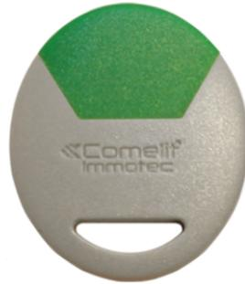
Badge électronique de Proximité CLE programmable avec les logiciels RÉSILIGHT, LAGUNE, RÉSIDOR OU RÉSIPO La programmation s'effectue à l'aide d'un encodeur USB. - Format porte clé en matériau ABS Gravé. Dimensions : 41 x 35 x 4 mm. - 10 couleurs possibles par appartement.
