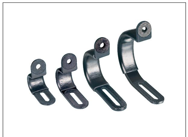
**Applications :** ces colliers universels préformés peuvent s'adapter à différents diamètres grâce à une rainure de réglage. Le revêtement caoutchouc permet de fixer des faisceaux de câbles délicats ou des éléments soumis à des vibrations.
