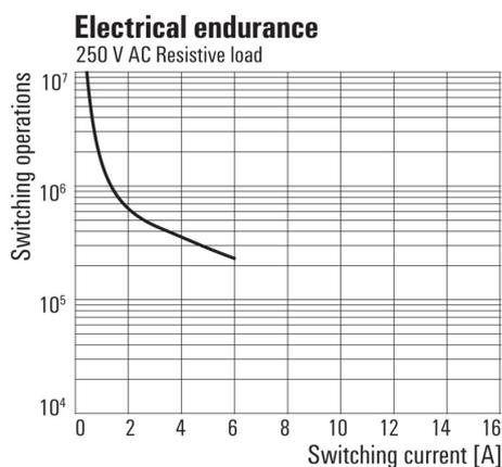
Durée de vie électrique 250 V AC resistive load
