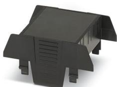
Boîtier électronique sur rail DIN, Partie supérieure du boîtier, design haut, ouverture de raccordement des deux côtés, largeur: 52,6 mm, hauteur: 75 mm, profondeur: 36,95 mm, coloris: noir (9005)
