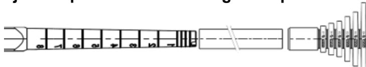
Une extension plastique doit être utilisée pour les profondeurs de perçage  $h_0 > 250$  mm
