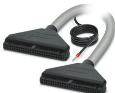
Câble rond préconfectionné et blindé avec raccordement de blindage supplémentaire et deux connecteurs femelles à 50 pôles surmoulés (liaison 1:1). Le câble est doté de deux connecteurs à 180°, longueur : 21 m
