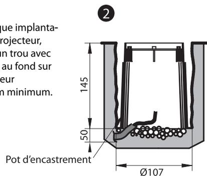
3 - Scellez le pot d'encastrement. Prévoir un joint de dilatation dans ciment ou béton.
