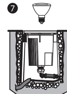
2- A chaque implantation de projecteur, creusez un trou avec drainage au fond sur une hauteur de 50 mm minimum.
