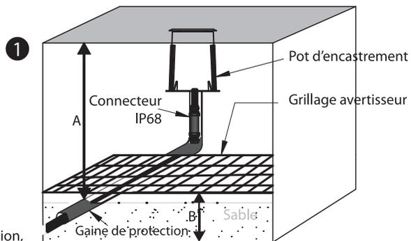
6 - Visser l'appareil sur le pot scellé au sol.
