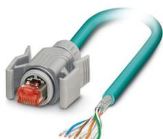
Câble Ethernet préconfectionné, CAT6, blindé, 4 paires, AWG 26 souple (7 fils), RAL 5021 (bleu lagon), connecteur gris RJ45/IP67, noir sur extrémité non terminée, Line, longueur 5 m
