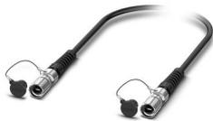
Série M17 MPO avec assemblage de connecteurs à fibre optique préconfectionné : connecteur mâle-connecteur mâle 24 pôles, fibre de verre multimode G62.5/125 µm OM1 avec raccordement vissé, longueur du câble fibre optique : 55 m, indice de protection IP67 après insertion, installation fixe dans des goulottes, des goulottes souterraines et des tubes de protection de câbles pour une utilisation en intérieur et en extérieur
