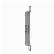
**Cartouche fusible, grande vitesse, 20 A, AC 690 V, 90 kA, BS88, 9 x 75 mm, aR, BS, entraxes de fixation 64,3 mm**
