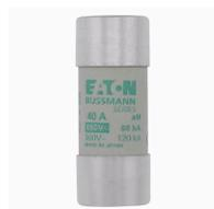
**Cartouche fusible, Basse tension, 40 A, AC 690 V, 80 kA, 22 x 58 mm, aM, IEC, avec percuteur**
