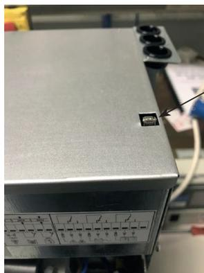
Attention présence d'un capteur d'ouverture sur le dessus à droite
