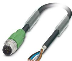
Câble pour capteurs/actionneurs, 5-pôles exempt d'halogène, blindé, connecteur mâle droit M12, détrompage: A, câblé avec déconnecté, sur extrémité libre, longueur de câble: 5 m, sans PATG
