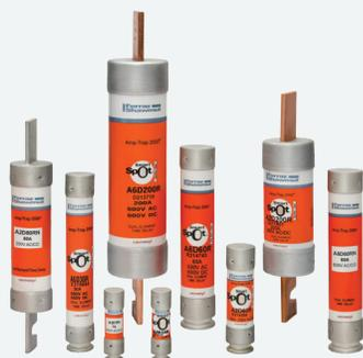
Les fusibles Amp-Trap® A2D-R et A6D-R fournissent la protection CEI Type 2 "sans dommages" aux circuits principaux, d'alimentation et de distribution pour tous les types de charge. Leurs caractéristiques de temporisation sont idéales pour les courants d'appel, et avec leur capacité de limitation de courant et une importante gamme de calibres (de 1 à 600 ampères), les fusibles A2D-R et A6D-R fournissent une excellente protection à toutes vos applications.
