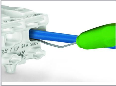
Démontage d'un connecteur enfiché : insérer l'outil de desserrage en dessous du conducteur et retirer le conducteur conjointement avec l'outil de desserrage.
