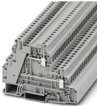
Bloc de jonction à plusieurs étages, tension nominale: 500 V, intensité nominale: 30 A, nombre de connexions: 4, type de raccordement: Raccordement vissé, Section de référence: 4 mm<sup>2</sup>, section : 0,14 mm<sup>2</sup> - 6 mm<sup>2</sup>, Raccordement vissé, Section de référence: 4 mm<sup>2</sup>, section : 0,14 mm<sup>2</sup> - 6 mm<sup>2</sup>, type de montage: NS 35/7,5, NS 35/15, coloris: gris
