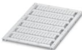
Repères pour blocs de jonction, Plaque, blanc, vierge, repérable avec : THERMOMARK PRIME, THERMOMARK CARD, BLUEMARK CLED, BLUEMARK LED, LASER TOPMARK, Type de montage: Encliquetage dans la rainure de repérage élevée, pour bloc de jonction au pas de : 4,2 mm, Surface utile: 3,6 x 10,5 mm
