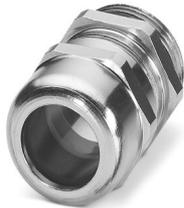
Presse-étoupe, matériau du raccordement vissé: Laiton, nickelé, diamètre extérieur du câble 18 mm ... 25 mm, blindage: non, filetage de raccordement: 1"-NPT, coloris: argenté, avec joint torique
