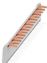
Pont de câblage pour modules avec pas de raccordement 17,5 mm, monophasé, 8 pôles, section transversale 35 mm<sup>2</sup> et embouts montés
