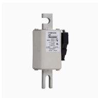
**Cartouche fusible, grande vitesse, 400 A, AC 1250 V, 100 kA, compact size 1, 45 x 58 x 138 mm, aR, DIN, IEC, indicateur de type K**
