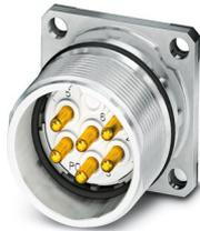
M23, Embases paroi avant, série: CA, droit, blindé: oui, Pour verrouillage standard et SPEEDCON, Nombre de pôles: 8+1, Sens de rotation: standard, type de contact: Mâle, Raccordement soudé, Joint plat, 4x Ø 3,2, cote de bride: 25 mm x 25 mm, détrompage: N, Produit de remplacement selon RoHS II sans exception 6c (Pb < 0,1 %) référence : 1243927
