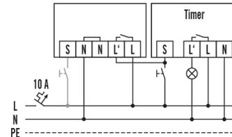
Raccordement sur minuterie et commande optionnelle par poussoir
