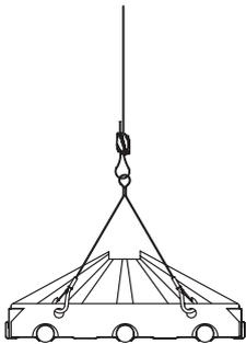
Y Accessoire embouts Crochets sur panneau radiant
