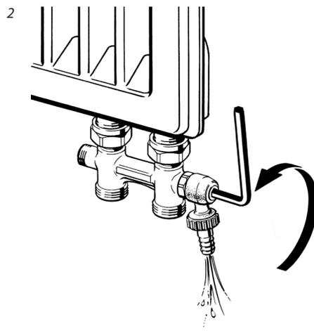
Une fois le robinet de vidange monté (1), ouvrir en tournant la clé Allen (2).
