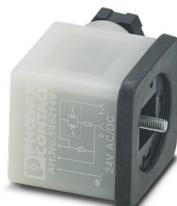
Connecteur pour électrovannes, Universel, 3-pôles, Connecteur de vanne A, Raccordement vissé, presse-étoupe M16, diamètre extérieur du câble 6 mm ... 8 mm
