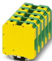
Bloc de jonction pour conducteur de protection, avec vis à six pans creux, nombre de connexions: 2, nombre de pôles: 1, type de raccordement: Raccordement vissé, Section de référence: 50 mm<sup>2</sup>, section : 16 mm<sup>2</sup> - 50 mm<sup>2</sup>, type de fixation: Pied PE avec vis de fixation, M6, type de montage: NS 35/7,5, NS 35/15, NS 32, coloris: vert/jaune
