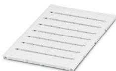
Repères pour blocs de jonction, Planche, blanc, vierge, repérable avec : BLUEMARK ID COLOR, BLUEMARK ID, BLUEMARK CLED, PLOTMARK, CMS-P1-PLOTTER, type de montage: encliquetage, pour bloc de jonction au pas de : 10,2 mm, surface utile: 9,6 x 10,5 mm, Nombre d'étiquettes: 48
