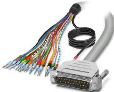
Câble rond blindé préconfectionné; raccordement 1 : Fils individuels (25-pôles) (Les fils sont repérés et équipés d'embouts. La tresse de blindage sort d'une extrémité de câble distincte.); raccordement 2 : Connecteur mâle D-SUB (1x 25-pôles); longueur de câble: 1 m
