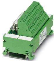
Module VARIOFACE, connexion à ressort, avec connecteur femelle Sub-D, se monte sur profilé NS 35/7,5, 25 pôles
