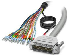
Câble rond blindé préconfectionné; raccordement 1 : Fils individuels (25-pôles) (Les fils sont repérés et équipés d'embouts. La tresse de blindage sort d'une extrémité de câble distincte.); raccordement 2 : Connecteur mâle D-SUB (1x 25-pôles); longueur de câble: 2 m
