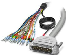
Câble rond blindé préconfectionné; raccordement 1 : Fils individuels (25-pôles) (Les fils sont repérés et équipés d'embouts. La tresse de blindage sort d'une extrémité de câble distincte.); raccordement 2 : Connecteur mâle D-SUB (1x 25-pôles); longueur de câble: variable
