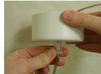
Visser le serre-câble pour bloquer
