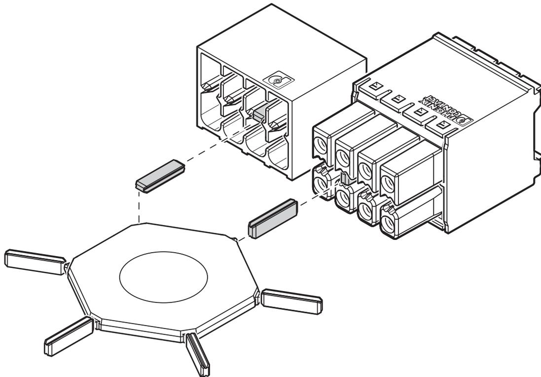
Utilisation de la languette de détrompage CP-DMC...
