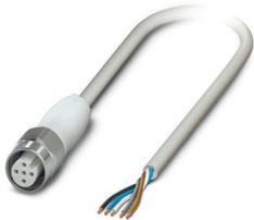
Câble pour capteurs/actionneurs, 5-pôles exempt d'halogène, extrémité libre, sur Connecteur femelle droit M12, détrompage: A, longueur de câble: 1,5 m, Conception hygiénique, avec molette inox
