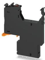
Adaptateur pour fiche de fusible à utiliser sur un bloc de jonction de base PLC de 6,2 mm. Pour fusibles 5 x 20 mm. Tension de service : 120 ... 230 V AC/DC. Avec LED pour l'affichage de la défaillance des fusibles.
