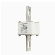
**Cartouche fusible, grande vitesse, 900 A, AC 690 V, 200 kA, size 2, 61 x 77 x 135 mm, aR, UL, IEC, sans voyant, modèle nord-américain, Entraxes de fixation 115 mm**
