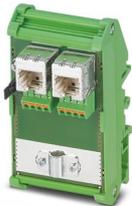
Module de partage de câbles, deux connecteurs femelles RJ45 avec disposition Ethernet (sortie de câble vers l'avant), sur 8 bornes de raccordement à ressort, CAT5e, 10/100 MBit/s, montage sur profilé, IP20, contact du blindage avec le profilé par cavalier au choix
