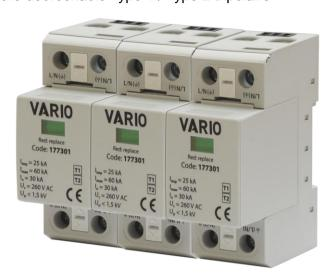
paratonnerre suivant NFC15-100/C15-443. Compatible avec les systèmes paratonnerre de niveau II à IV suivant NF EN 62305-3. Le niveau de protection Up 1.5kV, permet une protection Type 1 / Type 2 sans coordination.
