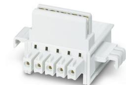
Connecteurs sur profilé, coloris: gris clair, intensité nominale: 8 A (contacts parallèles), tension de référence (III/2): 125 V, nombre de pôles: 5, pas: 3,81 mm, montage: Montage sur profilé, verrouillage: sans, type de fixation: sans, type de conditionnement: emballé dans un carton, Article avec contacts dorés, connecteur de bus pour le raccordement de boîtiers électroniques, 5 contacts parallèles
