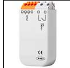
S.2495 DALI RELAY SWITCH pour ON-OFF (NON GRADABLES) 230V APPAREILS Tous les appareils fonctionnant à 230V non gradables (ON-OFF) peuvent être contrôlés ON-OFF avec le système DALI avec les accssoires interfaces suivants. Il s'en suit que l'appareil sera contrôlé à distance dans le seul mode ON-OFF et non pas en mode gradable. IP20 Max nominal load 1000VA Max switching current 8A Max inrush current 80A Dimensions 32,5mm x 15mm x 58,5mm
