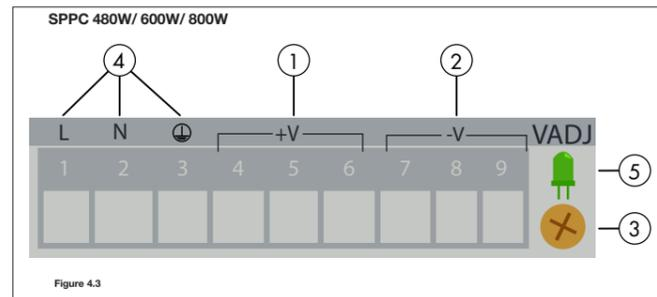
**Connection specification • Specifiche di collegamento • Spécifications de câblage • Especificaciones de conexión • Angaben zum Anschluss • Tilslutningsspecifikation • Спецификация подключения • 连接规范**
