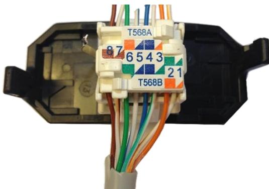
2. Refermer les 2 clapets jusqu'au « Click » : les fils sont sertis et bloqués. Insérer ensuite le bloc dans le support. Procéder de même pour le second.
