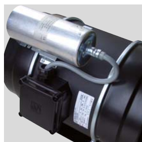
Boîte à bornes extérieure, étanche IP55 condensateur spécial ATEX Boîte à bornes étanche IP55, très accessible, en plastique ignifuge V0.
