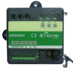
Interface sur BUS SimpleHome 3 entrées de type impulsional à relier aux compteurs avec sortie à impulsions (par ex. eau, gaz, calories). Reliée à un superviseur (Mini Touch ou Planux Manager), permet de visualiser les consommations sous forme de graphiques ou de tableaux. Montage par encastrément ou sur rail DIN. Dimensions 42x42x18mm (1 module DIN).
