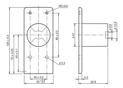
avec entretoise pour arbre de diamètre 20 mm avec entretoise pour arbre de diamètre 30 mm
