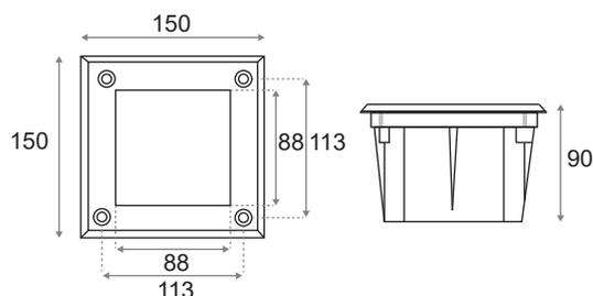
Pour les applications extérieures, un système de drainage doit être utilisé sous le socle d'encastrement pour faciliter l'évacuation des liquides.
